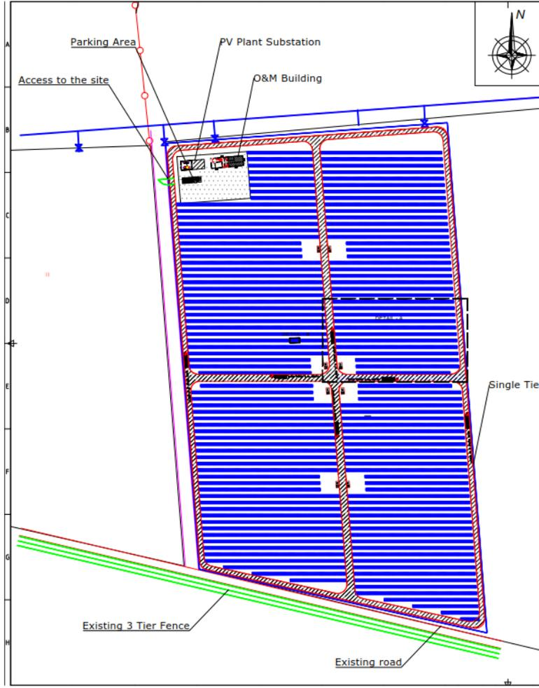
شكل 3-5- مخطط نمطي لمحطة كهرباء شمسية كهروضوئية
